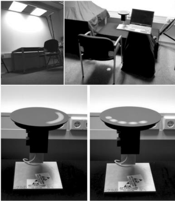
Abbildung 2: Testaufbau aus [3], [4] und [5]: oben links: Die über dem Tisch montierten Leuchten, oben rechts: Versuchsaufbau mit einer Drehscheibe, unten links: Drehscheibe unter (kontinuierlichem) Gleichlicht, unten rechts: Drehscheibe unter moduliertem Wechsellicht
